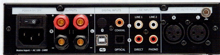
4040 Aのリアパネル。アナログ入力はRCA端子2系統とXLR端子1系統。デジタル入力はRCA同軸、光TOS、USB Type Bの3系統。日本仕様モデルはBluetoothは非対応。スピーカー出力端子は1系統
